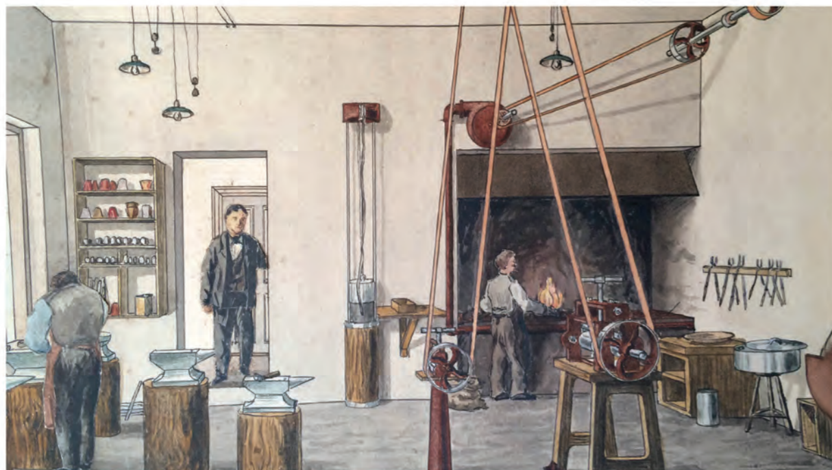
Skitsetegnning fra 1905 af produktion og valserum i fabrikken på Hobrovej, hvor tydeligt ses remmene fra dynamoerne, der driver de forskellige maskiner.
